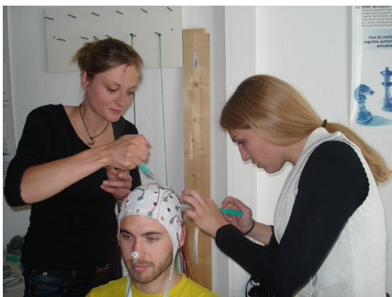
Abbildung 8: Montage der Elektroden auf der Messhaube (mit freundlicher Genehmigung des Probanden).
