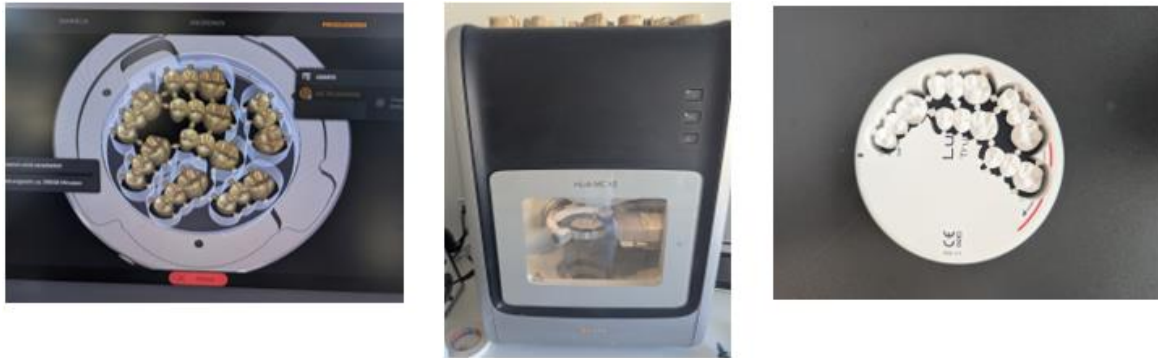
Abbildung 10 – Fräsvorgang - digitale Platzierung der Werkstücke innerhalb der Disc, Fräsvorgang, Gefräste Werkstücke
