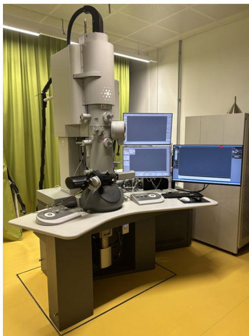
Abbildung 2: Darstellung des FEI Tecnai G2 20 Elektronenmikroskopes (mit freundlicher Genehmigung der Core Facility Ultrastructure Analysis der Medizinischen Universität Graz)
