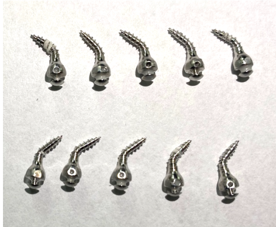
Abbildung 23: Edelstahlmischschrauben nach der Versuchsdurchführung
