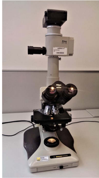
Abbildung 33: Nikon Optishot-2 wurde zur Beurteilung der Präparate verwendet (eigenes Foto)
