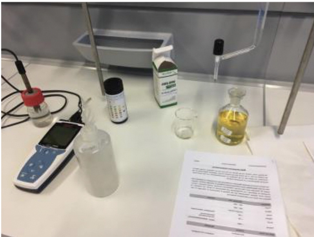
Abb. 2: Urinanalyse mittels pH-Meter 2
