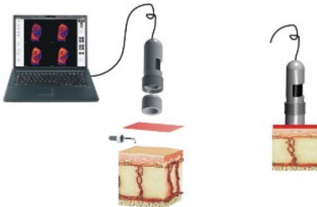
Abbildung 23: Das LROI-System. Die Sensorfolie ist rot dargestellt, darüber befindet sich das sterile Röhren mit dem Mikroskop, das über ein USB-Kabel mit dem Laptop verbunden ist (98).
