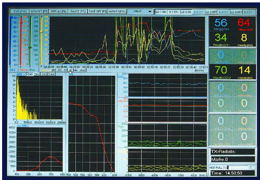
Abbildung 27: Abbildung der Messdaten auf dem O2C-Monitor. Blau: Sauerstoffsättigung, Rot: Hämoglobinkonzentration, Grün: Blutfluss, Gelb: Blutflussgeschwindigkeit (113).
