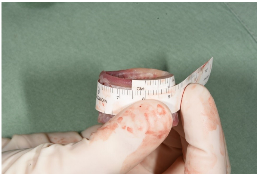
Abbildung 36: Messung des Umfanges der Direct Flow Medical TAVI-Prothese
