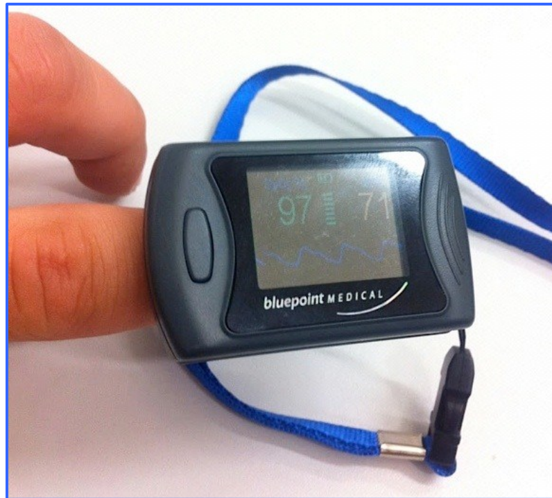
Abbildung 8: SpO 2 -Messung mittels Pulsoxymetrie am Zeigefinger
