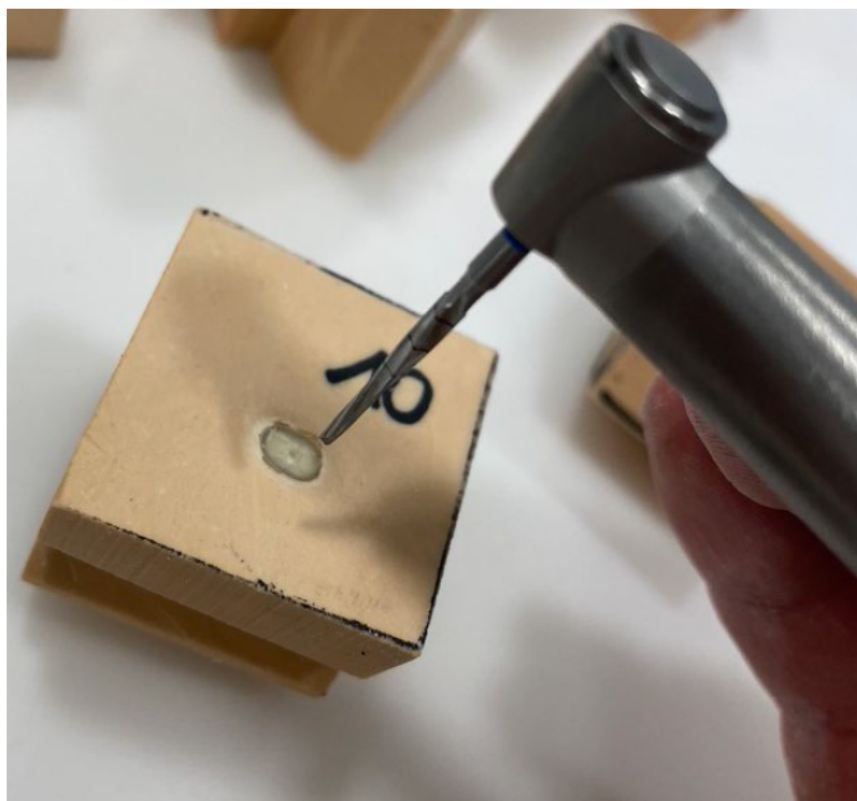
Abbildung 11: Aufbereitung mittels systemspezifischer Bohrer
