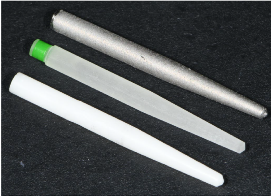
Abbildung 7: Teststifte aus Zirkonoxid, Chrom-Kobalt, Quarzfaser
