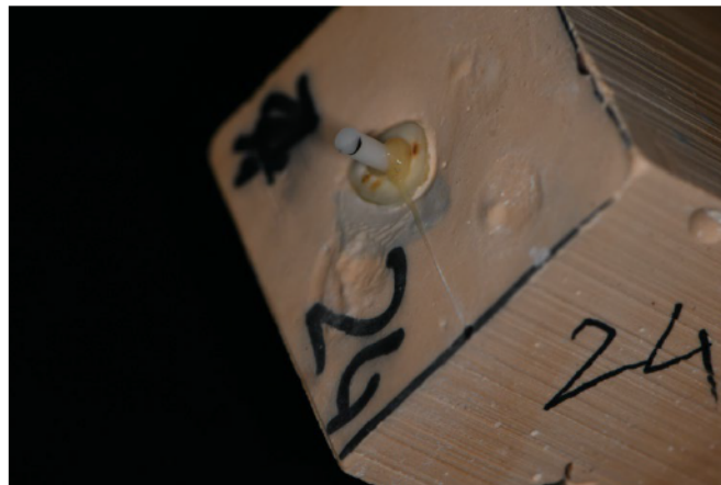
Abbildung 12: Gipsblock mit dem Zirkonoxidstift
