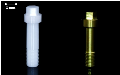
Abbildung 9 links: Abutmentschraube aus Zirkon (BL-OSC-H) rechts: Abutmentschraube aus Titan (BL-OST-H, Z-System) (29)
