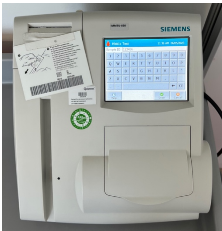
Abbildung 18: Schließen des Deckels und Eingabe der Patient*innen Nummer
