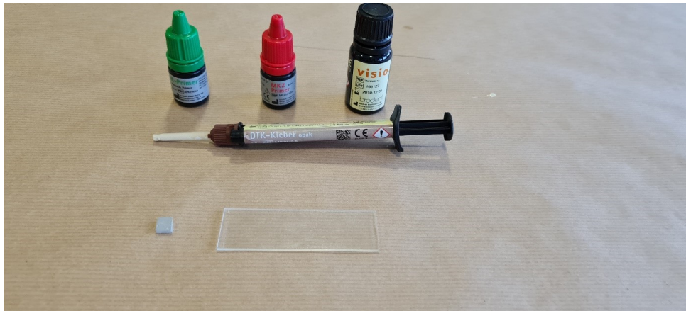
Abbildung 3 DTK – Kleber zur Fixierung der Proben an Objektträger.
