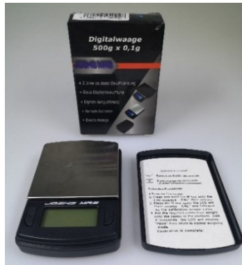
Abbildung 11 Waage zur Druckkalibrierung
