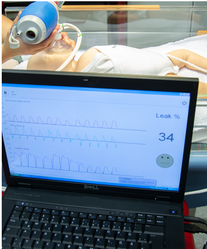
Abbildung 7: Beispielfoto der Beatmung mit Beutel-Maske (hier zu sehen Ambu® Mark IV) und zwischengeschaltetem Flow-Sensor (F10L screen pneumotachograph, GM Instruments Ltd., Großbritannien), Beatmungsparameter in Echtzeit am Respiratory Function Monitor
