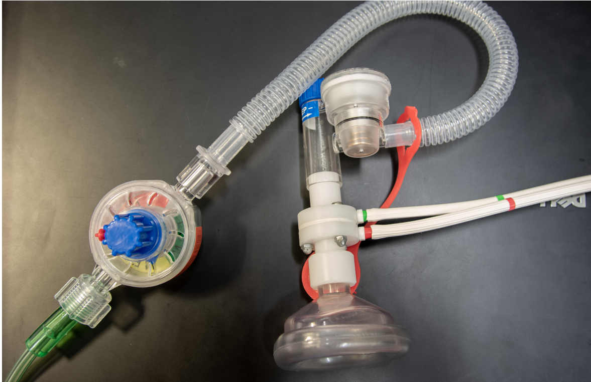
Abbildung 6: von links nach rechts: Sauerstoffschlauch, Neo-Tee® Infant T-Piece Resuscitator, Pneumotachograph des SMART Resuscitation Mask Leak Trainer und Gesichtsmaske
