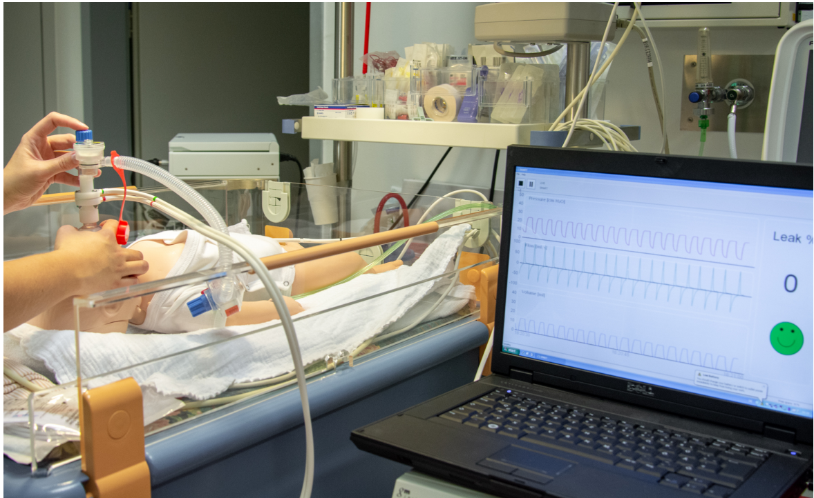
Abbildung 8: Beispielfoto des Versuchsaufbaus. Links: Neugeborenenmannequin beatmet mit T-Piece sowie zwischengeschaltetem Pneumotachographen des Respiratory Function Monitors Rechts: Echtzeitaufzeichnung der gemessenen Beatmungsparameter Anmerkung: in der realen Studiensituation waren die Beatmungsparameter für die Probandinnen und Probanden nicht einsehbar
