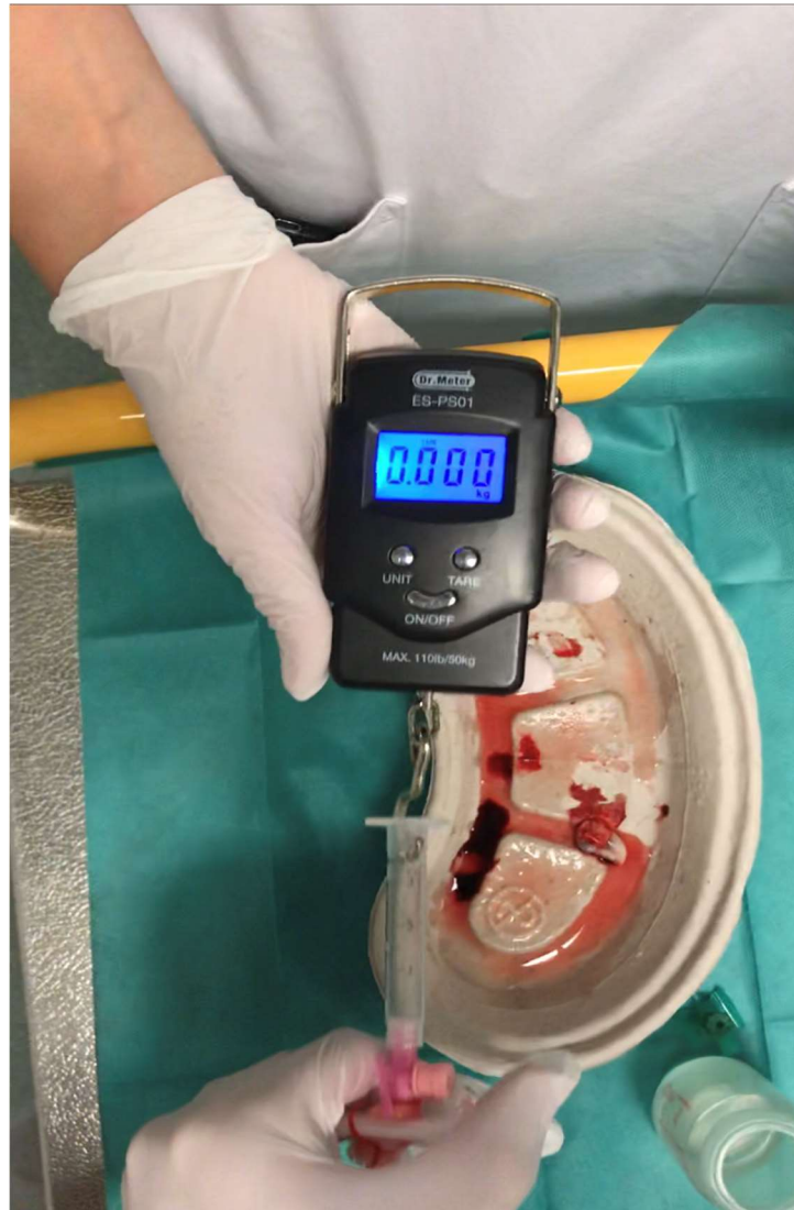
Abbildung 9: Messung der Kraft, die nötig ist, um die Fixation zu lösen, mittels elektronischer Federwaage.
