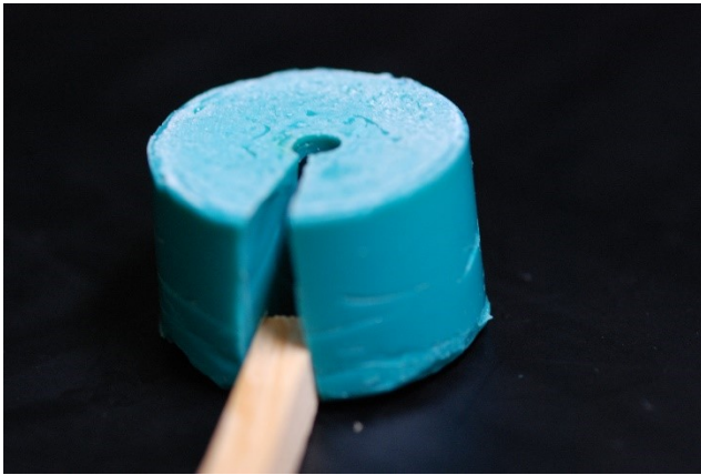
Abbildung 9: Einseitig geschlitzte Einbettungsform
