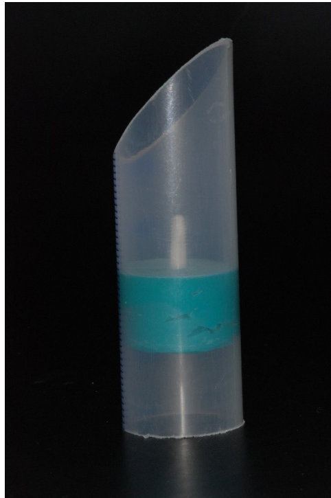
Abbildung 10: Im 45° Winkel abgeschnittene Kunststoffröhre inkl. Einbettungsform samt Implantat
