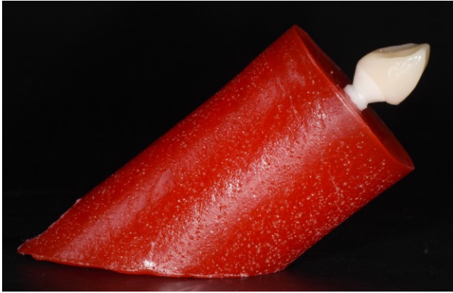
Abbildung 12: Eingebettetes Implantat in Pattern Resin LS im 45° Winkel
