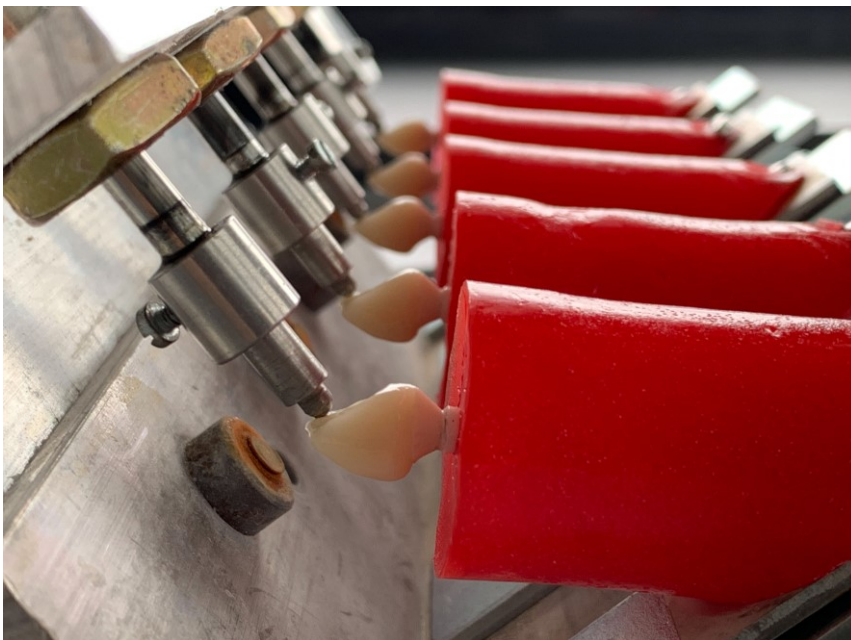
Abbildung 15: Proben im 45° Winkel und 2 mm unterhalb der Schneidekante belastet
