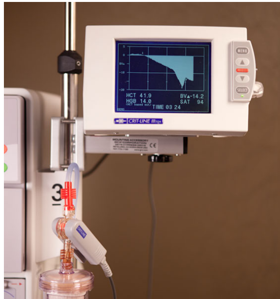
Abbildung 3.1: Setup CLM III während der Dialyse Zu sehen sind Monitor mit Bildschirm und Messclip unten links, der am arteriellen Senkel des Dialysators angebracht ist. Bildrechte: Fresenius [17]
