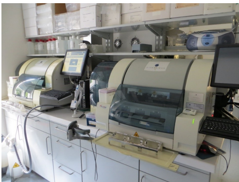
Fig. 12. The NucliSENS® easyMAG® instrument.
