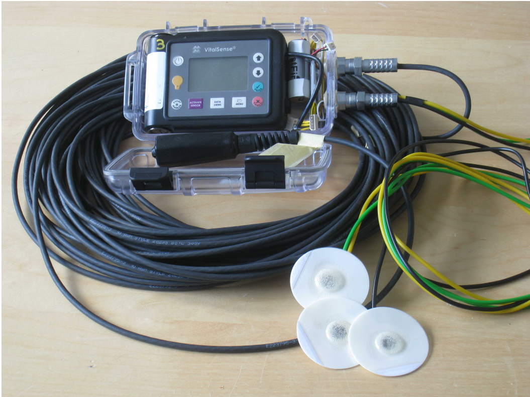
Abbildung 11: Gesamtsystem aus Körpertemperaturmessung und EKG
