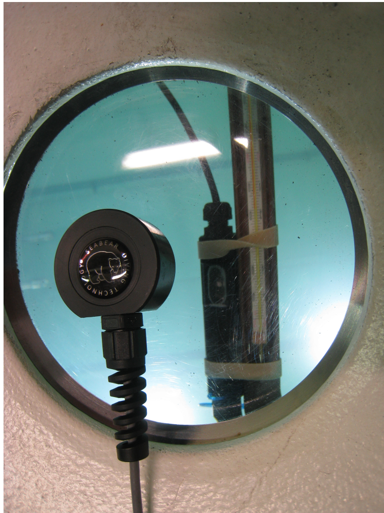
Abbildung 9: Infrarotübertragung: Sender und Empfänger
