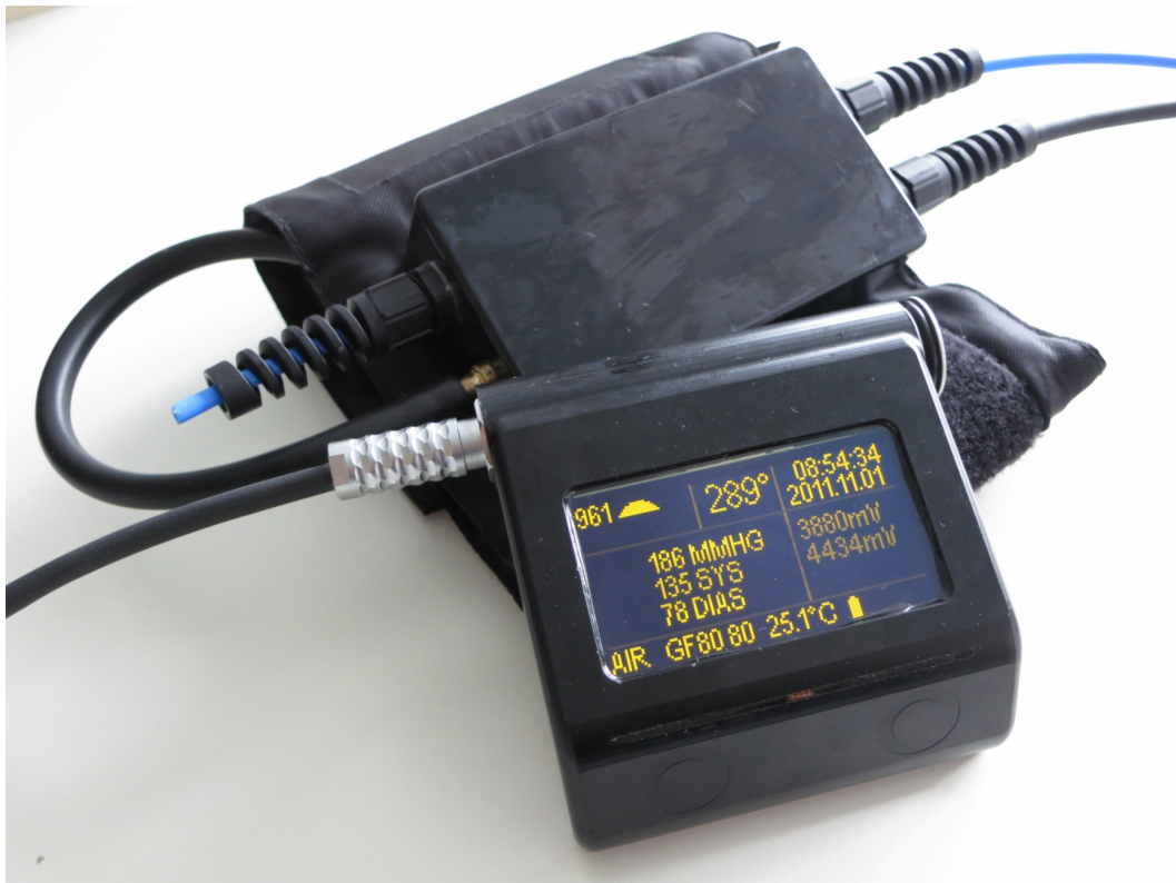
Abbildung 7: Prototyp eines Blutdruckmessgerätes mit luftgefüllter Manschette
