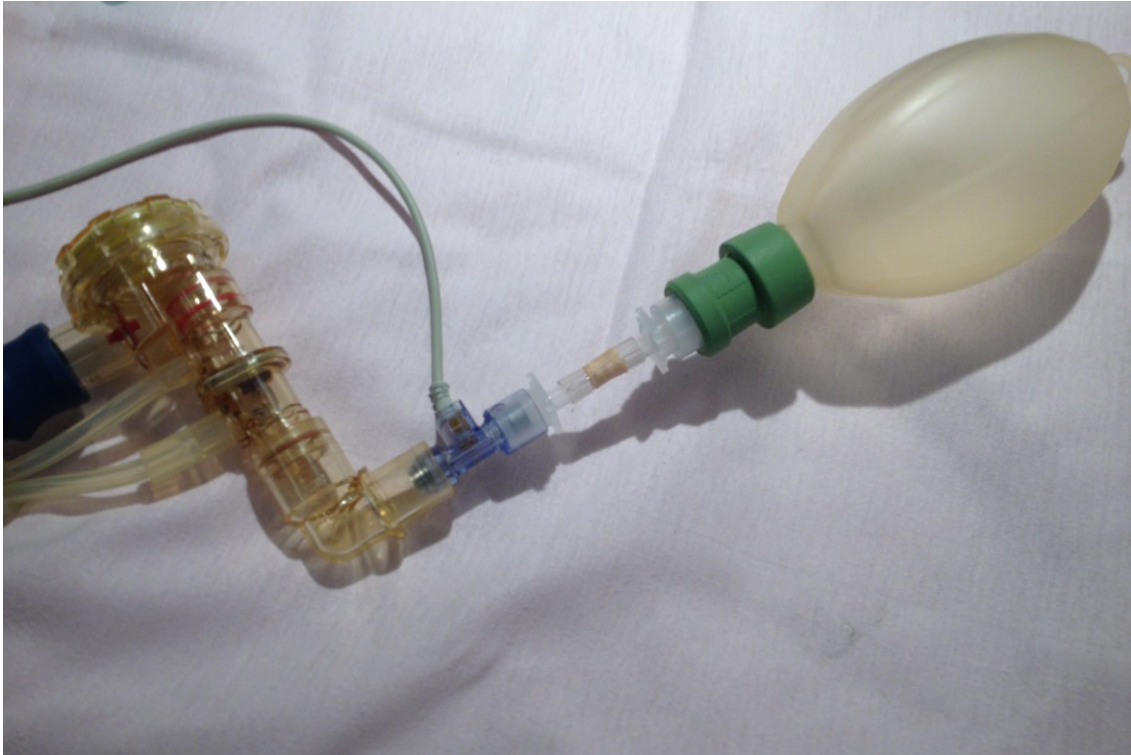
Abbildung 5: Versuchsaufbau (von links nach rechts): Oxylog 3000 -Beatmungsschlauch, Flowsensor, Interponat aus adaptierten Endotrachealtuben, Testlung VBM 0,5 Liter
