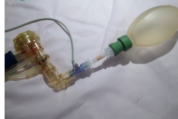
Abb.2: Versuchsaufbau: Oxylog 3000-Beatmungsschlauch, Flowsensor, Interponat aus adaptierten Endotrachealtuben, Testlung VBM 0,5 Liter
