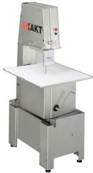
Abbildung 20: EXAKT –Diamantbandsäge (EXAKT Advanced Technologies GmbH 2014)
