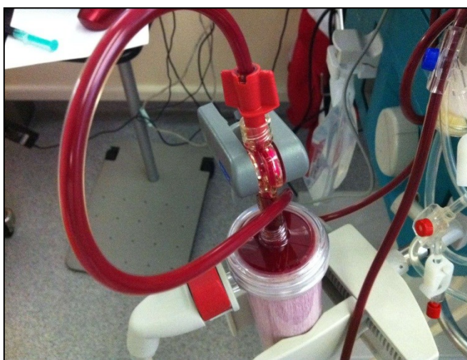
Abb. 14: CritLine Messkammer mit Sensorclip
