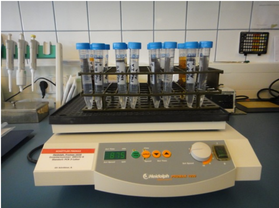
Abbildung 11 Exp.3 Silberproben auf Schüttelplatte
