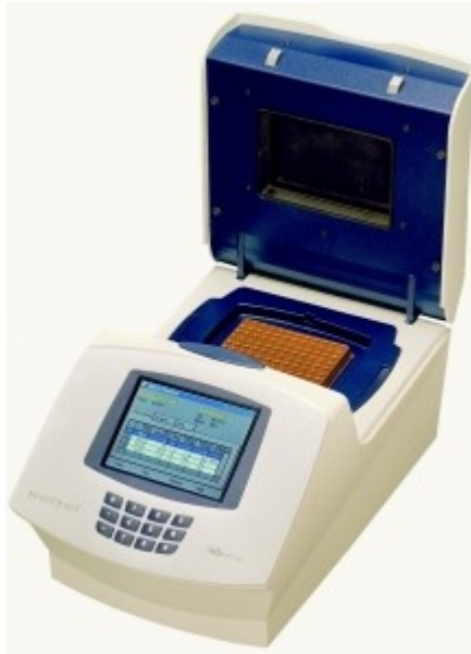
Abbildung 5: Versuchskammer für Temperaturwechselbelastung zur künstlichen Alterung der Versuchsproben
