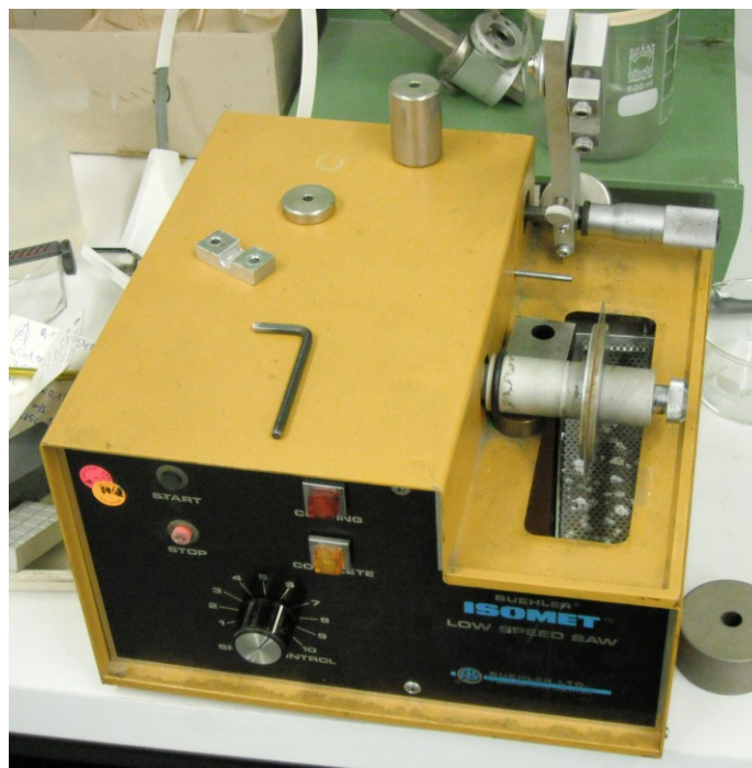
Abbildung 7: Isometsäge zur Zerteilung der Versuchsproben in zwei Hälften
