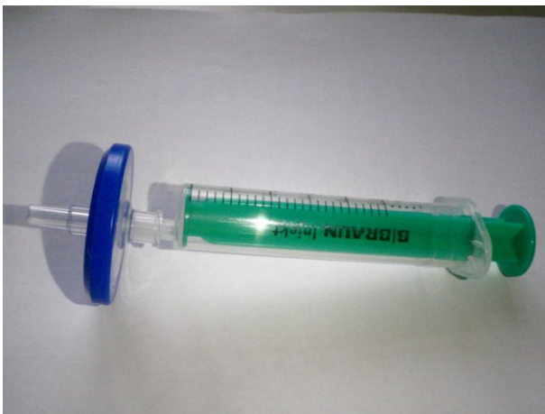
Abb. 19: Filter-Spritzen-Kombination zur Filterung der HY-WS
