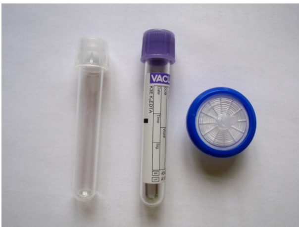
Abb. 18: 5ml Falcon ® Facs-Röhrchen, 3ml Vacuette ® -Röhrchen, 0,45µm MILLEX ® HA Filter Unit (von links nach rechts)
